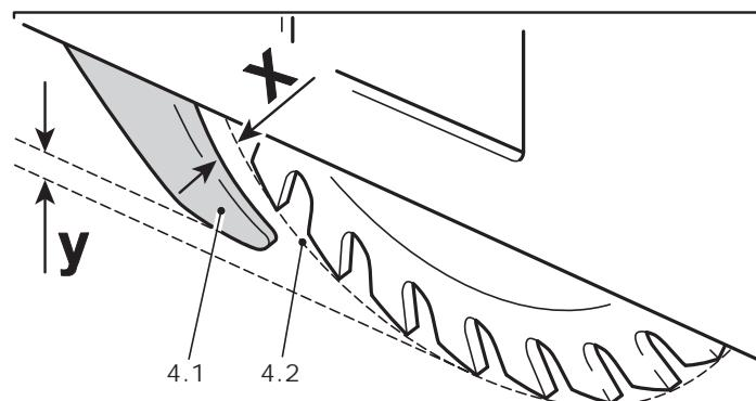
**ADVERTENCIA** La TS 75 EQ está equipada de serie con una cuña de incisión (4.1). ¡Por razones de seguridad, todos los trabajos de aserrado sólo deben ser llevados a cabo estando montada y correctamente ajustada la cuña abridora!
