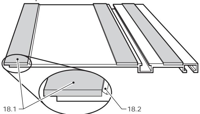
Tout pare-éclats endommagé ou usagé doit être remplacé :
