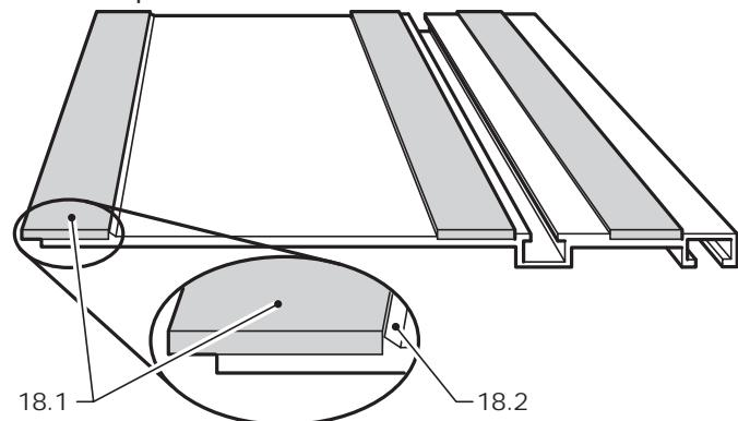
Debe sustituirse sin falta la protección contra astillas al apreciarse el menor síntoma de deterioro o desgaste:
