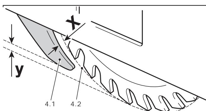
**AVERTISSEMENT** La TS 75 EQ est équipée en série d'un écarteur (4.1). Pour des raisons de sécurité, tous les travaux de sciage peuvent uniquement être réalisés avec un écarteur monté et correctement réglé !
