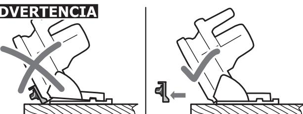
**Utilice la protección contra astillas sólo para cortes de  $0^\circ$ . Retire siempre la protección contra astillas al realizar cortes a inglete.** La protección contra astillas provoca que la sierra circular se desvíe al realizar cortes a inglete en la pieza de trabajo, por lo que pueden producirse lesiones graves.
