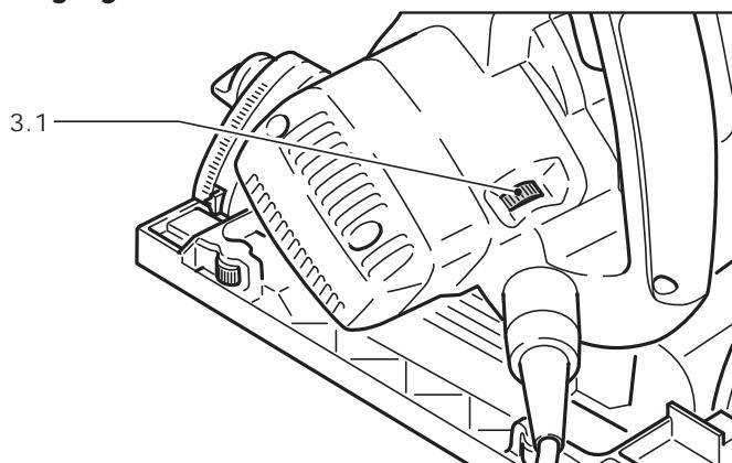
Le régulateur de vitesse (3.1) permet de régler progressivement la vitesse de la lame de scie entre 1350 et 3550 tr/min. Vous pouvez ainsi adapter de façon optimale la vitesse de coupe à chaque matériau.
