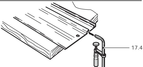
Los rieles guía disponibles en diferentes longitudes permiten unos cortes precisos, limpios, protegiendo al mismo tiempo la superficie de la pieza de trabajo ante posibles daños. En combinación con el extenso conjunto de accesorios, es posible efectuar con el sistema de guía unos cortes angulares, a inglete y unos trabajos de adaptación con gran exactitud.
