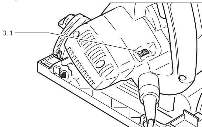
Con ayuda del regulador del número de revoluciones (3.1) se puede ajustar la velocidad de la hoja de sierra, sin escalonamientos, a un valor de entre 1350 y 3550 rpm. De esta forma, la velocidad de corte se puede adaptar de forma óptima a cada material.
