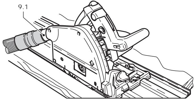
Il est possible de raccorder un aspirateur Festool d'un diamètre de tuyau d'aspiration de 36 mm ou 27 mm (recommandation: 36 mm à cause du risque de bourrage moins élevé) aux raccords d'aspiration rotatifs (9.1).
