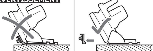
**N'utilisez le pare-éclats que pour les coupes à  $0^\circ$ . Pour les coupes en biais, enlevez toujours le pare-éclats.** Ce dernier risque de soulever la scie circulaire de la pièce et de provoquer des blessures graves.
